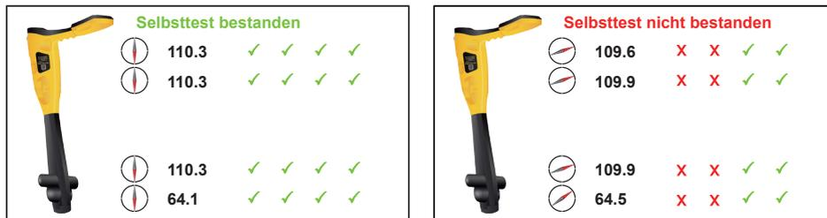
Wenn das Gerät den Test nicht besteht („Failed“), versuchen Sie es erneut in einem störungsfreien Bereich. Wenn das Gerät weiterhin ausfällt, senden Sie es zur Untersuchung und Reparatur an Vivax-Metrotech oder eines seiner zugelassenen Reparaturzentren.
