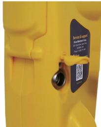
Schließen Sie das Ladegerät an die Lade-/Zubehörbuchse des Empfängers an. Schließen Sie danach das Ladegerät an den Netzanschluss an und schalten Sie es ein. Die LED-Anzeige am Ladegerät leuchtet so lange rot, bis der Akku-Block vollständig aufgeladen ist; danach wechselt die LED auf Grün.
