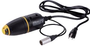
Mit dem LPC-Trennfilter (LPC) können Sie einen Signalton über eine handelsübliche Steckdose risikofrei in eine spannungsführende Leitung einkoppeln, sodass die Leitung vom Grundstück bis zum Anschluss auf der Straße verfolgt werden kann. Der LPC ist für den Anschluss an Spannungen bis 250V AC geeignet.
