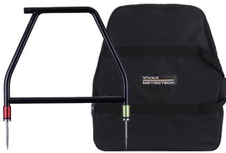
Der analoge A-Rahmen dient zur Ortung von erdfühli gen Fehlern an Rohren und Kabeln. Bei Rohren handelt es sich um Schäden in der Kunststoffummantelung. Bei Kabeln handelt es sich um Schäden in der Isolierung, wodurch der metallische Mantel (auch Kabelschirm oder Innenleiter genannt) in Kontakt mit dem Erdreich kommt.
