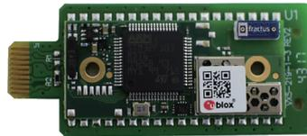
Als optionales Zubehör können die vLoc3-9800-Ortungsgeräte mit Bluetooth-Kommunikation ausgestattet werden. Das ermöglicht die Kommunikation mit externen GPS und Datenloggern. Die Bluetooth-Option kann auf Wunsch auch zu einem späteren Zeitpunkt bestellt und nachgerüstet werden.
