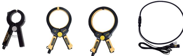
Mithilfe einer Sendezange kann das Signal des Senders induktiv in eine isolierte Leitung eingekoppelt werden, ohne den Sender dazu direkt an den Leiter oder Schirm anschließen zu müssen.
