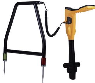
Der analoge A-Rahmen ist ein Zubehör für die Ortung von erdfühligem Fehlern an PE- oder bitumenbeschichteten Rohren und Kabeln. Bei Rohren handelt es sich um Schäden in der Kunststoffummantelung. Bei Kabeln handelt es sich um Schäden in der Isolierung, wodurch der metallische Mantel (auch Kabelschirm oder Innenleiter genannt) in Kontakt mit dem Erdreich kommt.
