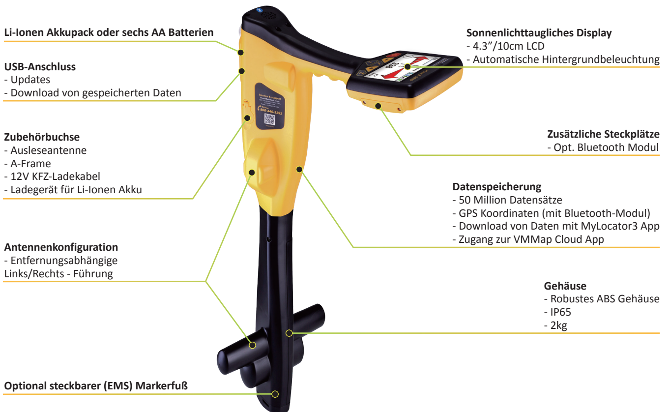
Leitungsortung mit Links-/Rechts-Führung und Kompass Permanente Tiefen- & Stromanzeige
