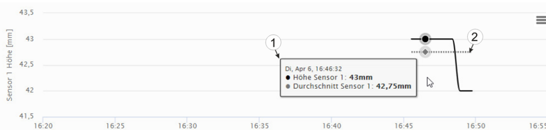
Darstellung der im Zuge des Setup-Modus ermittelten Füllhöhe
