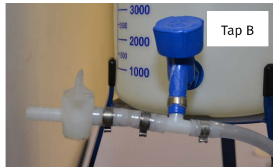
Fig. 11 Turn tap B 'On'
