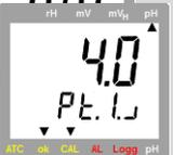
Stellen Sie die Elektrode und den Temperaturfühler (falls vorhanden) in die zweite Puffer-Lösung. (z.B. bei Standard-Serie: pH 4.0 oder pH 10.0) und rühren Sie vorsichtig um.
