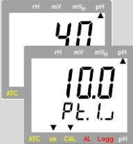
Stellen Sie die Elektrode und den Temperaturfühler (falls vorhanden) in die dritte Puffer-Lösung. (z.B. bei Standard-Serie: pH 10.0) und rühren Sie vorsichtig um.
