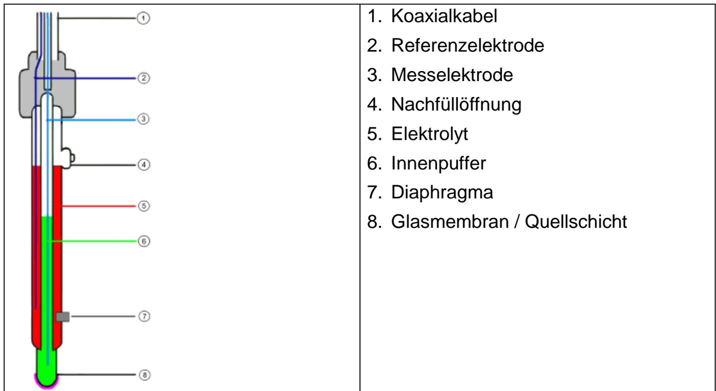
Das Diaphragma kann in unterschiedlicher Art und Weise ausgeführt sein, es bildet eine Verbindung zwischen Elektrolyt und der zu messenden Flüssigkeit. Eine Verstopfung oder Verschmutzung des Diaphragmas ist oft die Ursache für Fehlverhalten und Trägheit der Elektrode. Die Glasmembran ist sehr schonend zu behandeln. Auf ihr bildet sich die sogenannte Quellschicht. Diese ist entscheidend für die Messung und muss immer feucht gehalten werden.
