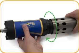
Entfernen Sie die Drossel aus dem Gerät.
