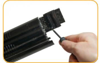
Ziehen Sie die Bürstenschraube mit dem Sechskantschlüssel fest.
