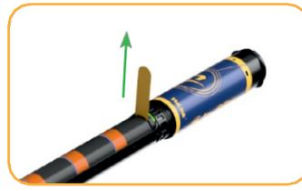
Entfernen Sie die gelbe Lasche, damit der Strom durch die Batterien fließen kann. Bringen Sie die Abdeckung wieder an.
