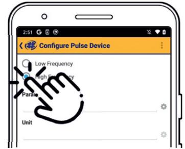
Hohe Frequenz: Wählen Sie **Hochfrequenz** und wählen Sie einen Parameter und eine Einheit.
