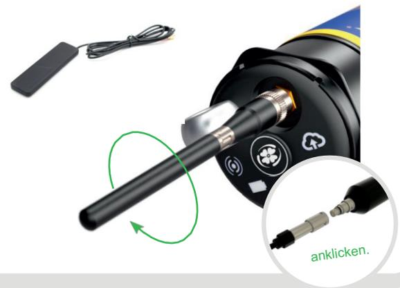
Nachdem Sie die externe oder eingebaute Antenne und das Gerät angeschlossen haben, folgen Sie den Anweisungen auf den nächsten Seiten dieser Schnellstartanleitung.
