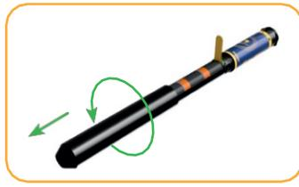
Entfernen Sie die Batterieabdeckung, indem Sie sie gegen den Uhrzeigersinn drehen und nach unten ziehen.
