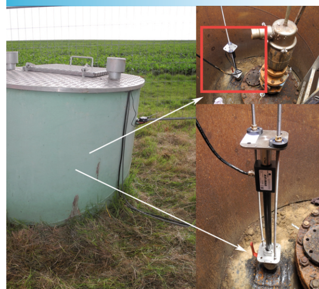
Die Anordnung der Sensorpaare repräsentiert flächengleiche Segmente
