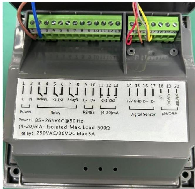
Abbildung 2-1 Schaltplan des Controllers
