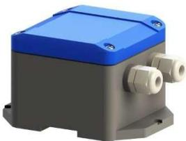
Der Anschlusskasten mit Schutzart IP 66 und wasserdichtem Belüftungselement bietet einen feuchtigkeitsfreien elektrischen Anschluss für den Tauch-Füllstandsmessumformer. Er sollte in einer trockenen Umgebung oder direkt im Schaltschrank montiert werden.
