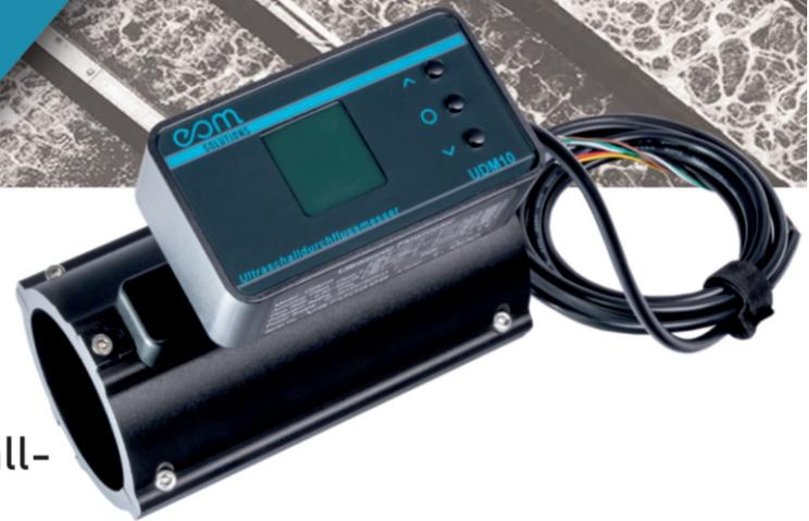
Der UDM10 ist ein Clamp-on-Ultraschall-Durchflussmessgerät für nicht-invasive Messungen auf gefüllten Rohrleitungen.
