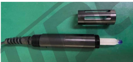
Abb. 4-1 Demontage der Schutzabdeckung der pH-Elektrode
