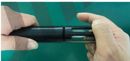
Abbildung 4-6 Anbringen der Schutzabdeckung
