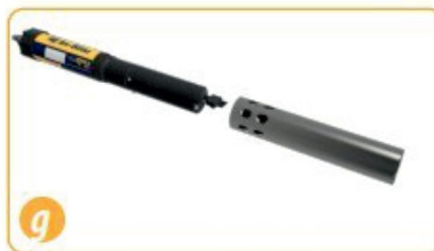
g) Klappen Sie den Begrenzer um und installieren Sie ihn mit Begrenzlöchern in der Mitte des Instruments zur Kalibrierung.
