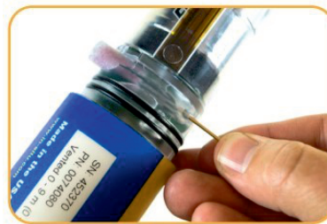
Führen Sie den Schraubenschlüssel in das Loch auf der Rückseite des Batteriefachs ein und drücken Sie die Trockenmittelkapsel heraus.
