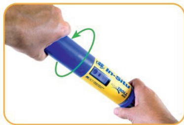
Entfernen Sie die Batterieabdeckung.
