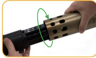
Setzen Sie die Drossel auf das Gerät im Kalibriermodus.
