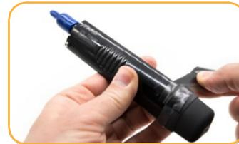
Bringen Sie die Kappen an beiden Enden des Sensors wieder an. Verwenden Sie Isolierband zum Verschließen der Aufbewahrungskappe.
