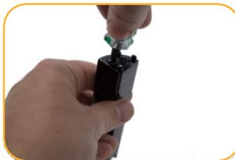
Entfernen Sie den Sensor von der Sonde und schrauben Sie die Referenzverbindung ab.
