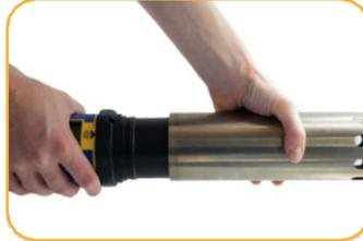
Nach der Kalibrierung drehen Sie die Drossel mit den Entlüftungslochern von der Mitte des Geräts weg.
