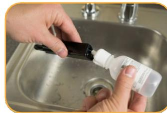
Führen Sie den Schlauch aus der Fülllösungsflasche in den Sensor ein.
