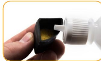
Befeuchten Sie den Schwamm in den Aufbewahrungskappen der pH/ISE-Sensoren mit der Aufbewahrungslösung oder dem pH-4-Kalibrierungsstandard.
