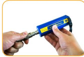
Richten Sie den TROLL Com-Anschluss auf das Kabelende aus. Drücken und drehen Sie, bis Sie ein Klicken hören.
