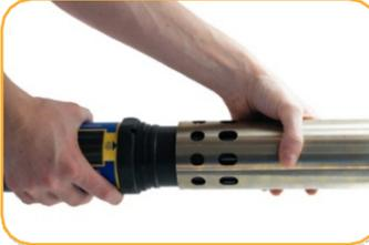
(Optional) Installieren Sie eine Drossel mit Entlüftungsloch an der Basis des Geräts für die Kalibrierung.
