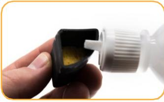
Befeuchten Sie den Schwamm in der Aufbewahrungskappe des Sensors mit der Aufbewahrungslösung oder dem pH 4-Kalibrierungsstandard.
