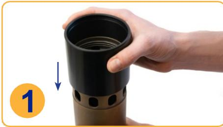
Lassen Sie die Drossel im Entfaltungsmodus. Schieben Sie die Kalibrierhülse über die Löcher.
