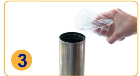
3. Nehmen Sie die Kappe vom Gerät ab und gießen Sie 20-40 ml DI-Wasser in den Drosselkörper.
