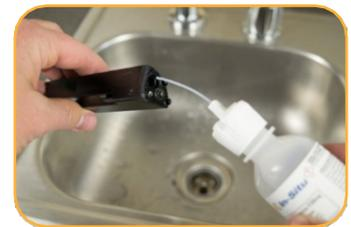
Drücken Sie die Lösung in das Reservoir, bis es voll ist. Ziehen Sie den Schlauch langsam heraus.
