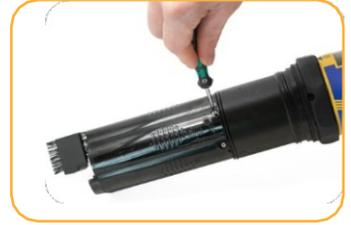
Ziehen Sie die Schraube an der Basis des Sensors mit einem Sechskantschlüssel fest. Nicht zu fest anziehen.
