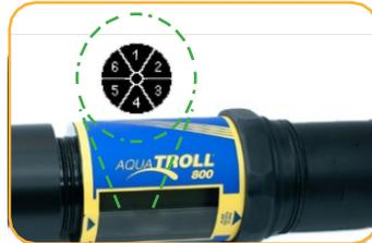
Auf dem LCD-Bildschirm wird der Status des Geräts angezeigt.
