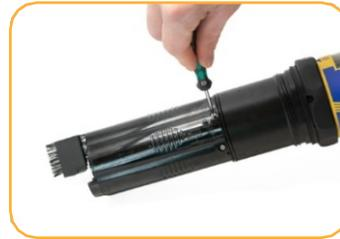
Ziehen Sie die Schraube an der Basis des Sensor mit einem Sechskantschlüssel fest. Nicht zu fest anziehen.
