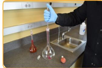
3. Um eine Konzentration von 200 µg/L zu erhalten, pipettieren Sie 2,0 mL der 100 mg/L-Lösung in einen 1000-mL-Kolben geben.
