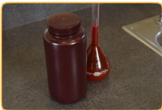
Verwenden Sie einen undurchsichtigen Behälter, um die 100 mg/L-Lösung an einem kühlen, dunklen Ort bis zu sechs Monate aufzubewahren.
