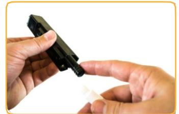
Schmieren Sie den O-Ring an der Unterseite des Sensors.
