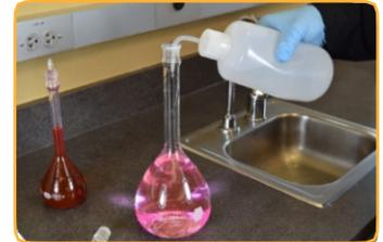
4. Der Kolben wird mit entionisiertem Wasser aufgefüllt.
