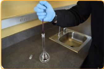
1. Beginnen Sie mit einer 2,5%igen Rhodamin-WT-Lösung. Pipettieren Sie 1,0 mg/L der Lösung in einen 250-mL-Messkolben der Klasse A.
