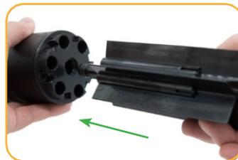
Installieren Sie die Drossel am Gerät.
