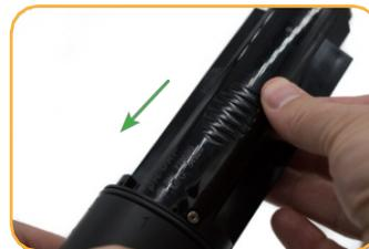
Die Welle des Abstreifers ausrichten und den Abstreiferstopfen in die mittlere Öffnung einsetzen.
