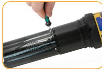
Lösen Sie die Stellschraube an der Basis jedes Sensors.
