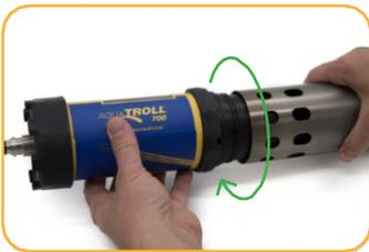
Entfernen Sie die Drossel aus dem Gerät.
