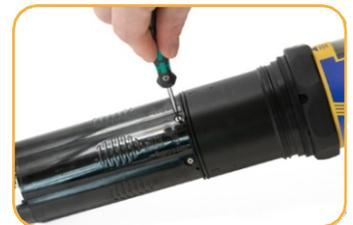
Sensoren einsetzen. Die Sensorzunge muss in die Nut des Wischersteckers gleiten.
