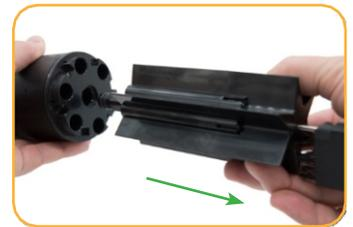
Entfernen Sie den Wischer, indem Sie ihn gerade aus dem Instrument herausziehen.
