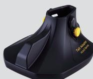
Der Standfuß wird an der Basis eines Empfängers der vLoc3-Serie montiert. Er ermöglicht einen sicheren Stand des Empfängers. Wenn er angebracht ist, erhöht er die Gesamthöhe des Empfängers um 8,5 cm. Die Firmware des Empfängers kompensiert die zusätzliche Höhe, um sicherzustellen, dass alle Tiefen- und Strommesswerte richtig bleiben.
